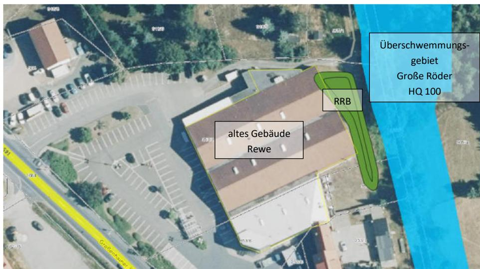
**Abbildung 1** Lage des geplanten RRBs mit dem Vergleich zum festgesetzten Überschwemmungsgebiet HQ 100 Große Röder. Quelle: <https://geoportal.sachsen.de>
